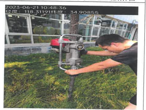
图 4 3#车间北脱氮深度处理系统东侧绿化带土壤现场采样图
