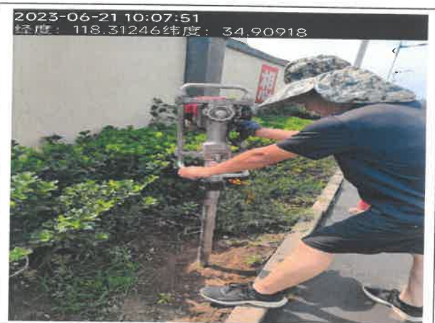
图 2 2#车间北污水处理站东空地土壤采样图
